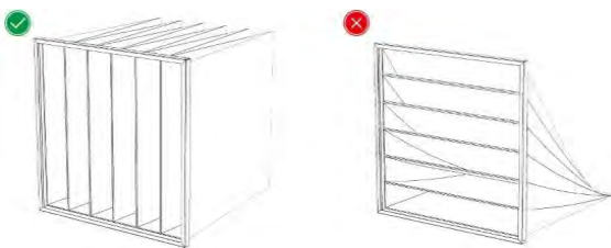
Abbildung 6.4.2.1 - Ausrichtung Taschenfilter.
